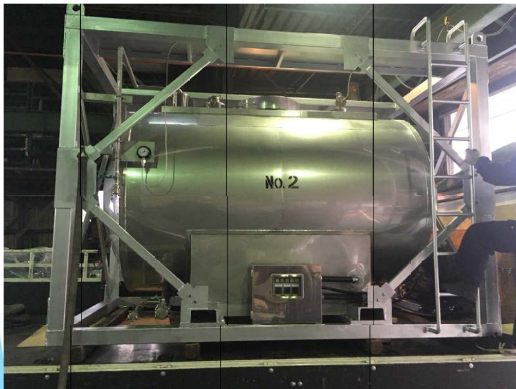
3000ℓ円筒横型電気ヒーター式加温コンテナ
