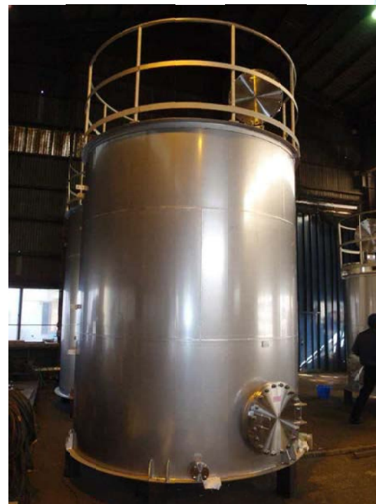
消防法20号タンク
