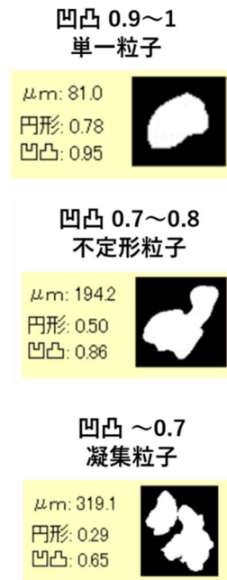
図3 粒子形状の凹凸度による圧縮可能粒子の判定
